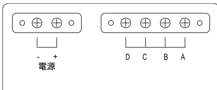
後述の「型式別入力仕様」に各端子の機能が説明してありますので、センサーを接続するときは、各端子の仕様とセンサーの仕様を合わせて接続してください。
